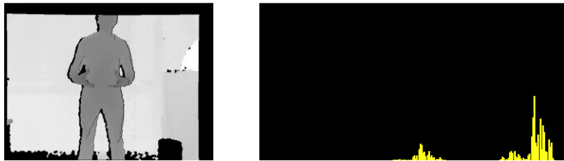
Hình 7. (a) - Ảnh độ sâu thu thập từ camera kinect. (b) - Lược đồ dữ liệu ảnh độ sâu;
