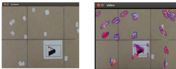
Hình 4. PUT và MUT (bên phải) tương ứng với mỗi điểm Harris phát hiện được (điểm đỏ bên trái)
