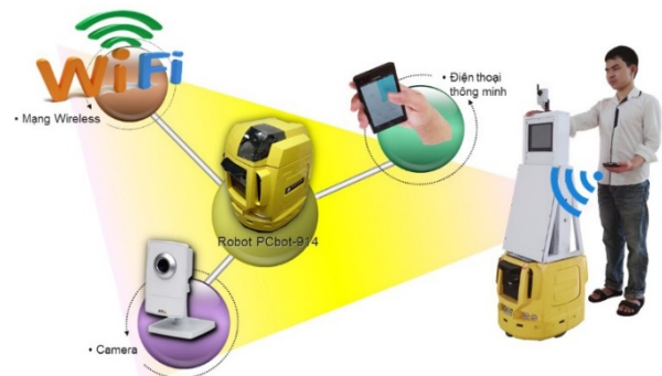
Hình 1. Các thành phần chức năng của hệ thống trợ giúp định hướng người khiếm thị sử dụng Robot di động
