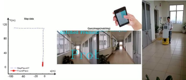
Hình 23. Hệ thống đề xuất dẫn đường người khiếm thị bằng mobile Robot
